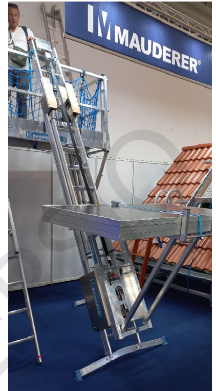
Kuva 29. Paneelihissi kuvattuna messuilla. Saatavilla on jopa 20 m päähän ulottuvia, taitoksin lappeelle kääntyviä hissejä. Hisseillä paneelien kuljetus maasta katolle onnistuu turvallisesti. Kuva Teemu Heikkinen
