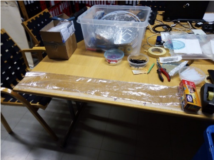
Kuva 4.1. Näytteen valmistus aloitetaan ottamalla sopiva pituus näytepussia.
