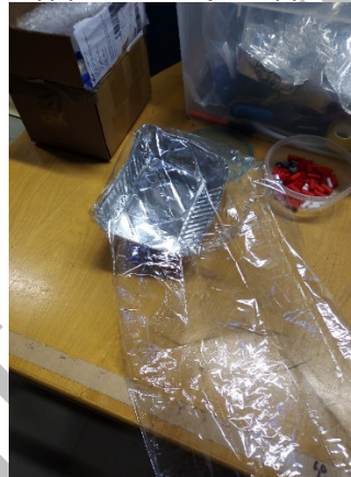
Kuva 4.4. Elintarvikelaatuinen alumiinivuoka asetetaan näytepussin pohjalle.
