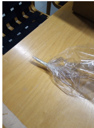
Kuva 4.2. Näytepussin pohja tiivistetään "rypyttämällä" ja teippaamalla pussi.
