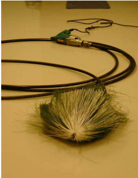
Kuva 10.4. Puhdistusharja ja sen pyörittämiseen käytettävä porakone.
