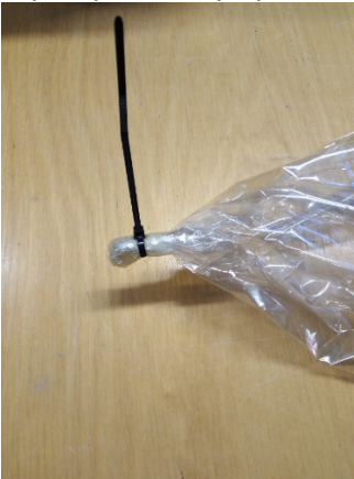
Kuva 4.3. Näytepussin tiivistys varmistetaan taittamalla ja kiristämällä.
