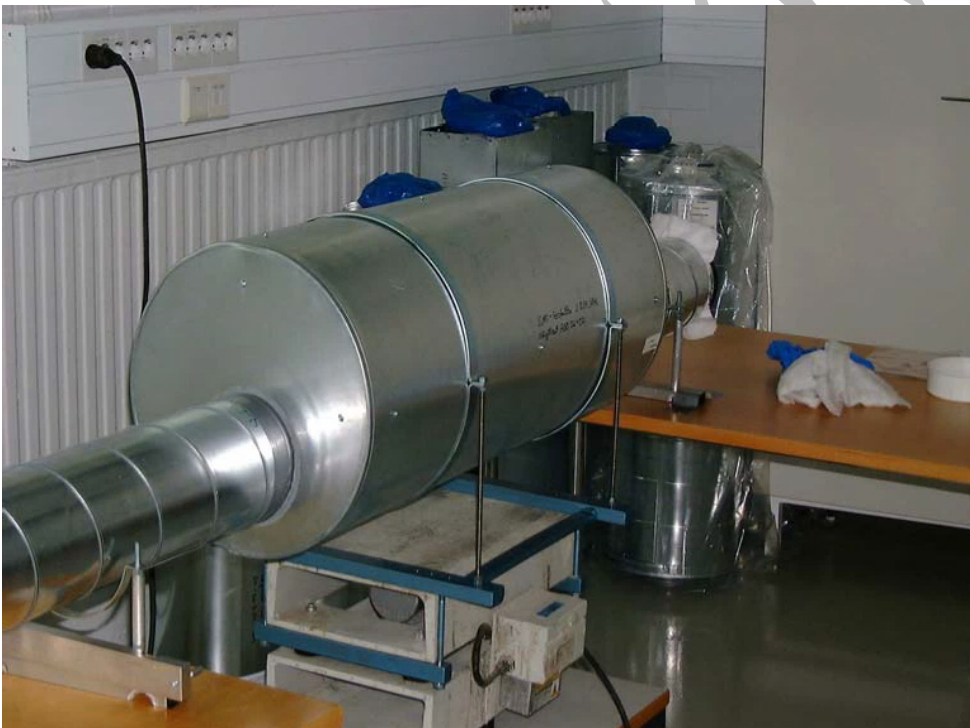
Kuva 10.2. Testattava tuote tärinäalustalla pantakiinnityksellä.
