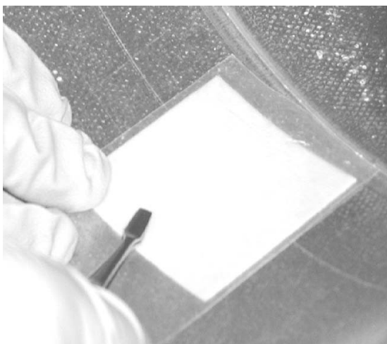
Kuva 6.1. Voiteluaineen näytteenotto ilmanvaihtotuotteesta suodatinimeytysmenetelmällä. Näytteenottimen painaminen pinseteillä.
