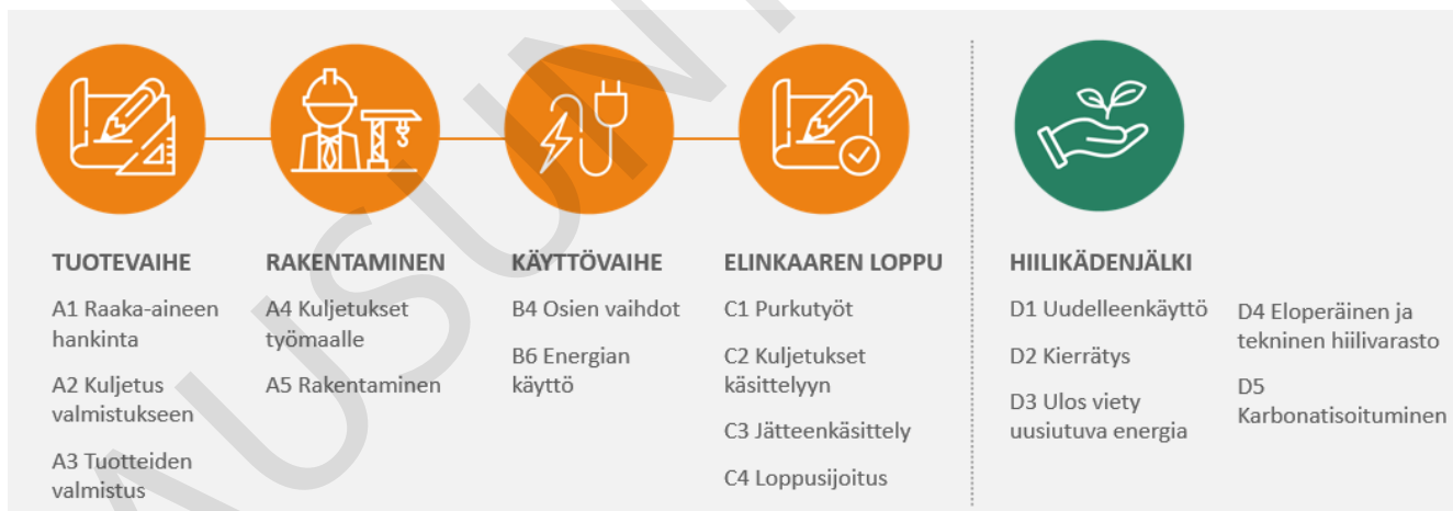
Kuva 1. Rakennuksen elinkaaren eri vaiheisiin viitataan EN-standardin mukaisilla kirjaintunnuksilla, joista A-vaiheet tapahtuvat ennen rakennuksen käyttöönottoa, B-vaiheet käytön aikana ja C-vaiheet käytön jälkeen elinkaaren lopussa. Hiilikädenjälki eli D-vaihe kuvaa hankkeen ilmastohyötyjä. Kuvassa on huomioitu ne elinkaaren vaiheet, jotka huomioidaan rakentamislain mukaisessa ilmastaselvityksessä.
