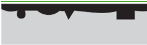
Kuva 2 Esimerkki ulkonäköluokan Ps0 ja Ps1 peittävästä käsittelystä. Valmispinta on tasainen.
