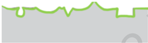
Kuva 8 Esimerkki ulkonäköluokan Ks3 kuultokäsittelystä. Valmiissa pinnassa esiintyy materiaalista johtuvaa karheutta ja epätasaisuutta sekä pienehköjä koloja, naarmuja, huokosia ja nystyröitä. Jos käsiteltävä pinta on puuta, saa puulajille ominainen rakenne näkyä.
