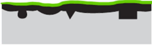
Kuva 6 Esimerkki ulkonäköluokan Ks2 kuultokäsittelystä. Valmiissa pinnassa esiintyy materiaalista johtuvaa lievää karheutta ja epätasaisuutta sekä pienehköjä koloja. Jos käsiteltävä pinta on puuta, saa puulajille ominainen rakenne näkyä.
