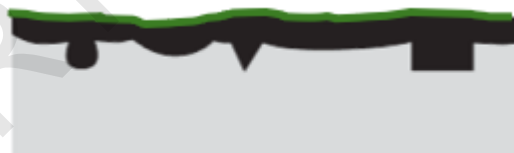
Kuva 3 Esimerkki ulkonäköluokan Ps2 peittävästä käsittelystä. Valmiissa pinnassa esiintyy alustasta johtuvaa lievää epätasaisuutta.
