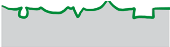
Kuva 4 Esimerkki ulkonäköluokan Ps3 peittävästä käsittelystä. Valmiissa pinnassa esiintyy alustasta johtuvaa epätasaisuutta sekä pienehköjä koloja, naarmuja, huokosia ja nystyröitä.
