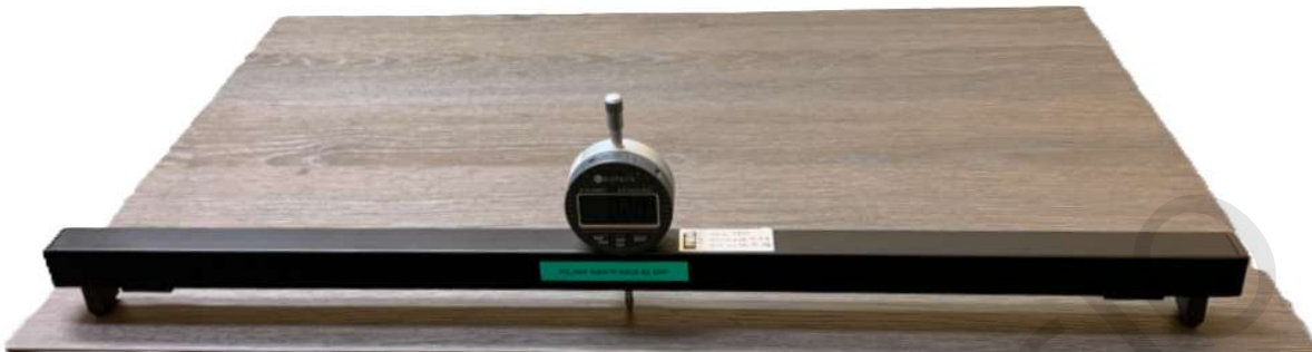
Kuva 5. Levyjen tasopoikkeaman mittausmenetelmä
